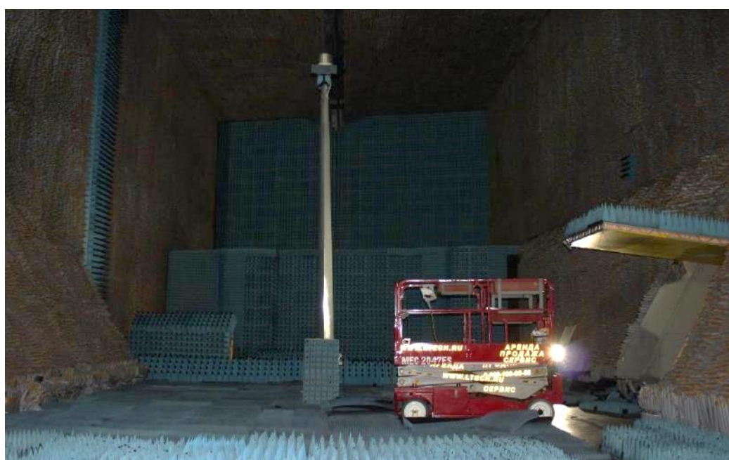
Рисунок 2 – Вид на заднюю стенку (и ворота БЭК), перегородку и РТО с установленным эталонным отражателем
