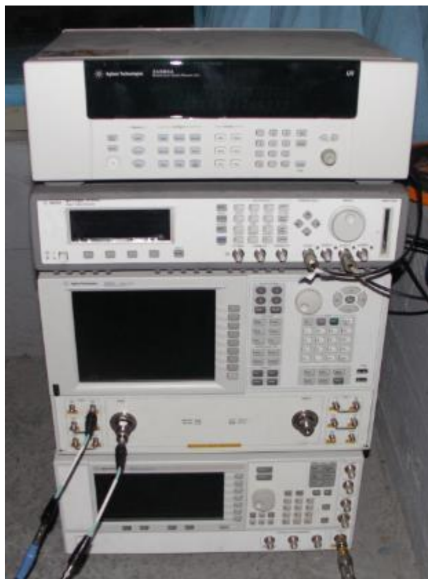
Рисунок 5 – Пример конфигурации СВЧ-оборудования (сверху вниз: коммутатор 34980А, генератор импульсов 81110А, ВАЦ E8363С и генератор сигналов E8257D)
